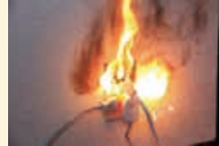
差し込みプラグ間で発生した トラッキング現象による出火(再現)
